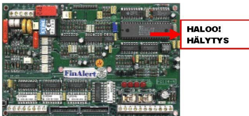
Kuva 72. robottipuhelin, joka on yleensä sijoitettu keskuslaitteen sisälle.
